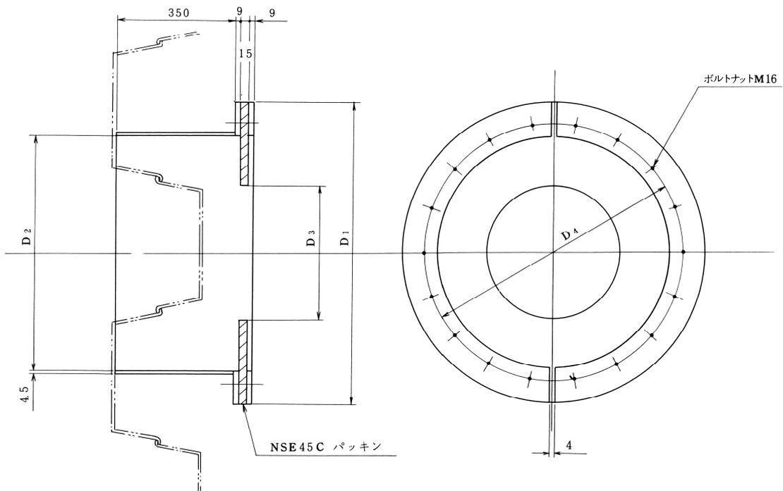
図 9-3 到達用坑口リング (呼び径 200~500)
