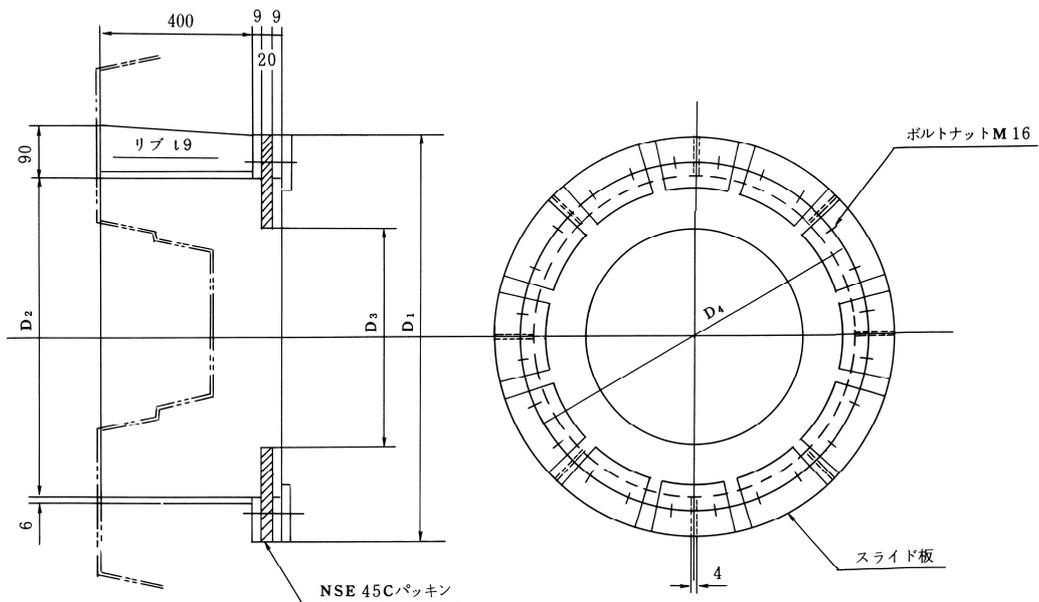
図 9-2 発進用坑口リング (呼び径 600~900)
