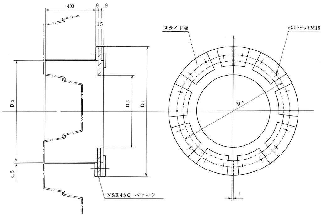
図 9-1 発進用坑口リング (呼び径 200~500)
