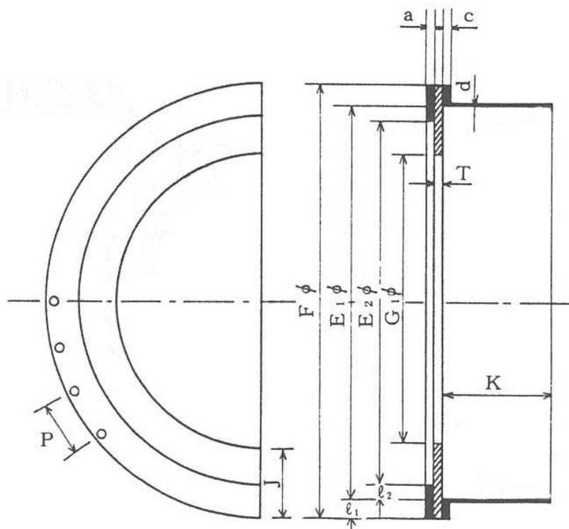
図 9-6 到達用坑口リング (呼び径 1650~3000)
