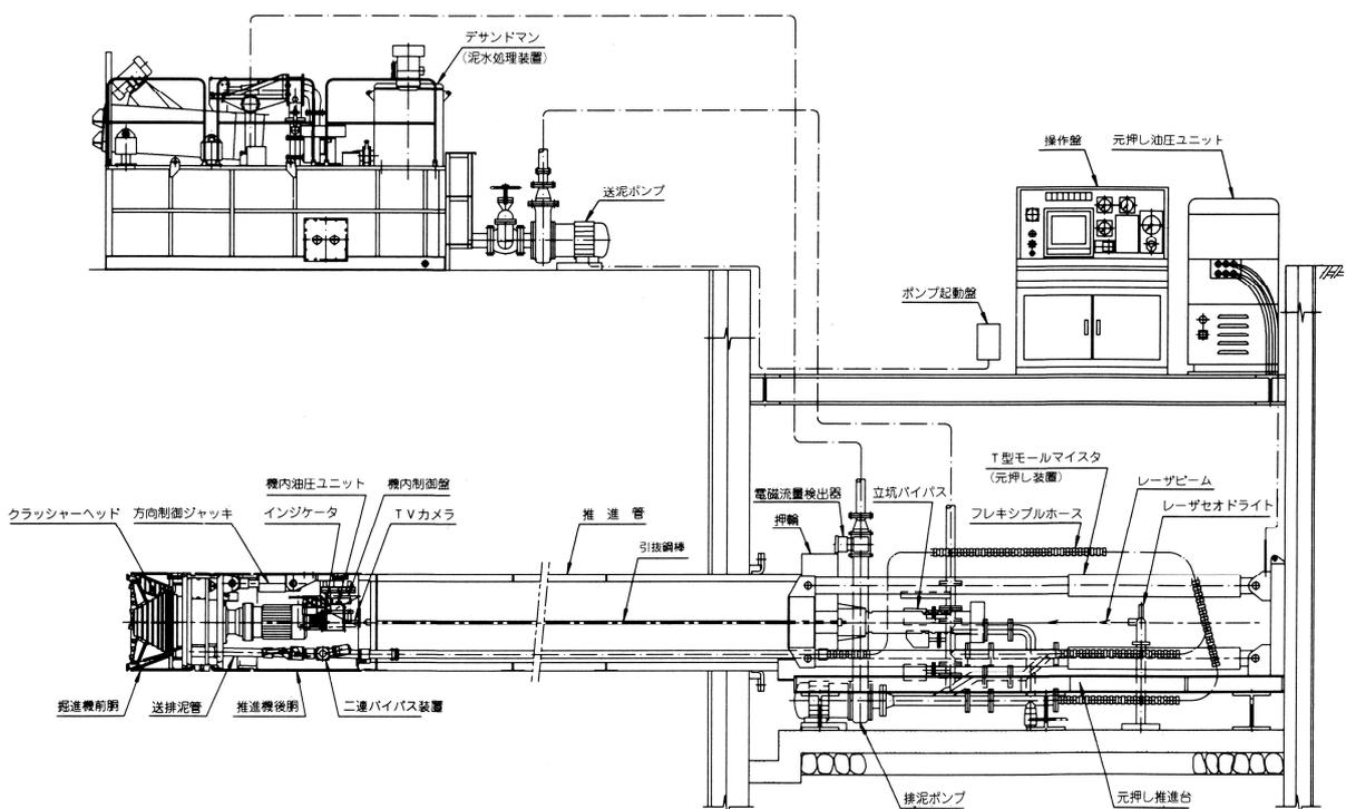
図 2-1 アンクルモール工法系統図
