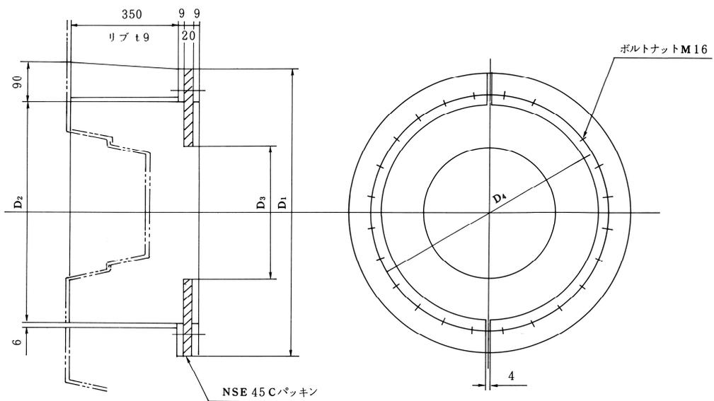
図 9-4 到達用坑口リング (呼び径 600~900)
